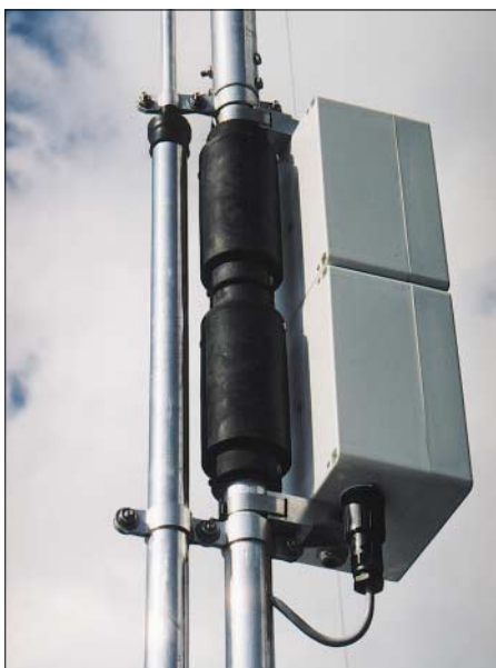
Bild 2: Kunststoffgehäuse mit wasserdichter Einführung des Steuerkabels
