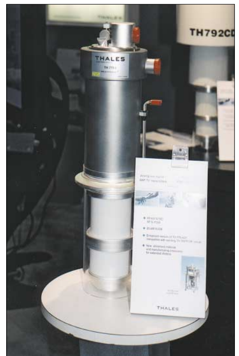
Für UHF-Fernsehsender entwickelte Thales Electron Devices eine Röhre, die Leistungen bis 25 kW bei digitalen Betriebsarten gestattet.
