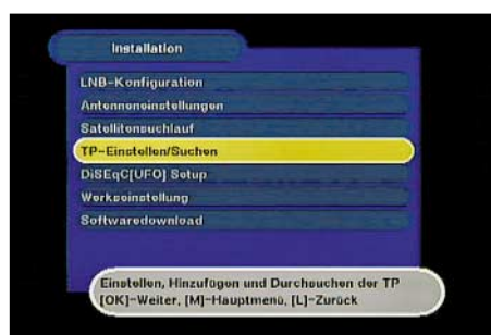
Bild 4: Der zweite Schritt beim Löschen besteht im Aufruf des Menüpunkts „TP einstellen/suchen“, wonach die Daten des Transponders angezeigt werden.
