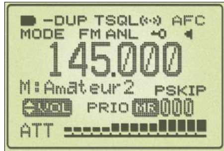
Das und noch mehr kann das Display praktisch darstellen: Links beim Einfach-Empfang und rechts beim Dualwatch-Empfang. Die Anzeigen wurden zur Veranschaulichung elektronisch generiert, zweimal MAIN ist natürlich nicht möglich.
