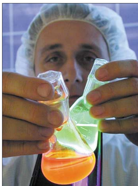
Polymerlösungen, die wie hier unter einer UV-Lampe in unterschiedlichen Farben leuchten, kann man auch als aktive Schicht in Matrix-displays benutzen.
