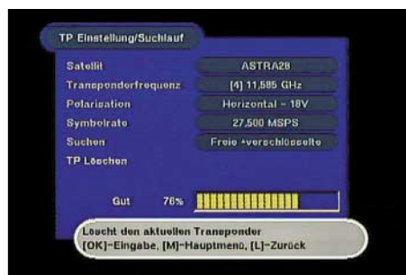
Bild 5: Nachdem man sich überzeugt hat, dass der Transponder keine interessanten Programme enthält, kann man ihn mit „TP löschen“ im dritten Schritt entfernen.
