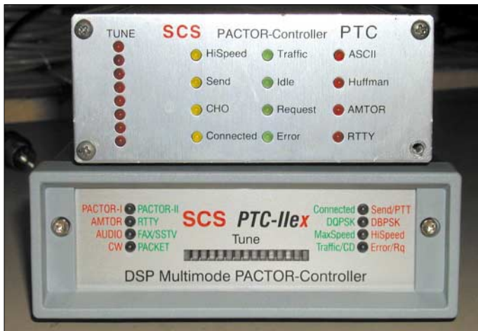
Bild 1: PTC-1 mit-Z80 (oben) und PTC-Ilex (unten)
