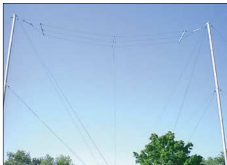
Die Antenne von WD2XFX ist eine klassische T-Antenne. Foto KD5UWL
