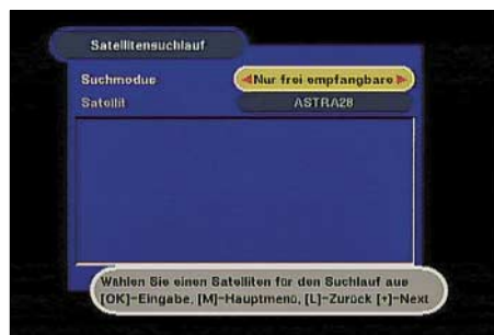
Bild 6: Den Suchlauf für einen ganzen Satelliten sollte man auf frei empfangbare Signale oder einzelne Transponder einschränken. Screenshots: DL2MCD
