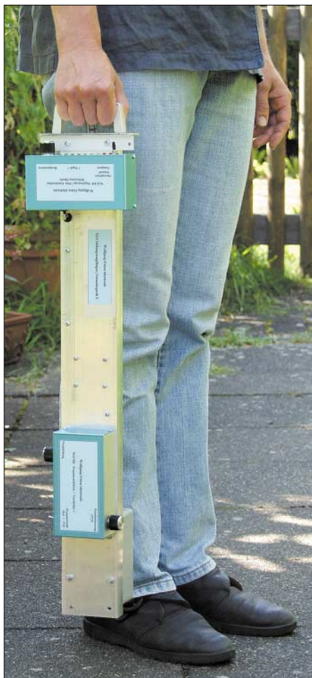
Bild 1: Durch den Aufbau auf ein Aluminium-U-Profil mit einer gewichtsmäßig ausbalancierten Aufteilung der Komponenten lässt sich das Ortungsgerät, hier Versuchsgerät 2, leicht tragen und bedienen.
