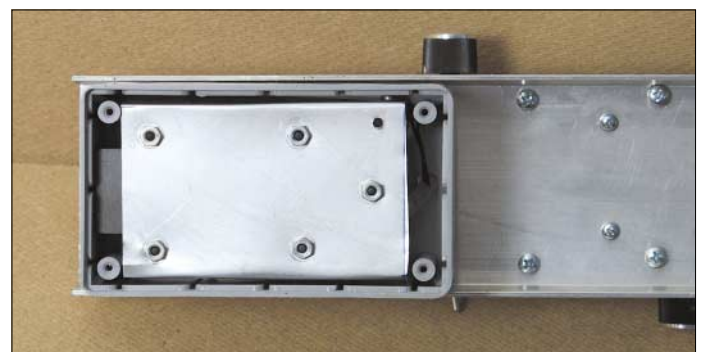
Bild 4: Im Antennengehäuse des Versuchsgeräts 3 befindet sich der 18 cm lange, ca. 3 cm x 3 cm starke Ferritkern, der mittig mit ausreichendem Abstand zur Schirmung zu montieren ist.
