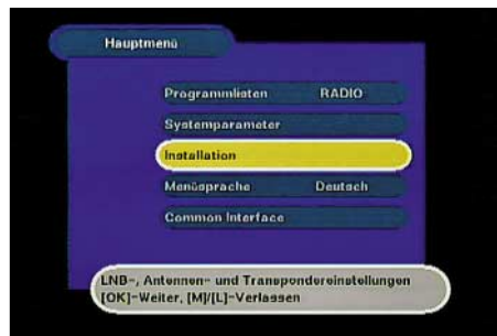
Bild 3: Um nicht benötigte Transponder im Receiver zu löschen, ruft man im ersten Schritt mit „M“ das Menü auf und wählt anschließend „Installation“ aus.
