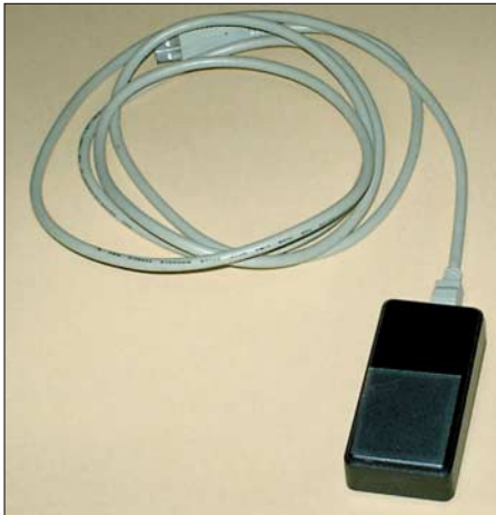
Bild 1: Die Sensoröffnung des Gehäuses wurde mit einer transparenten Folie bedeckt.
