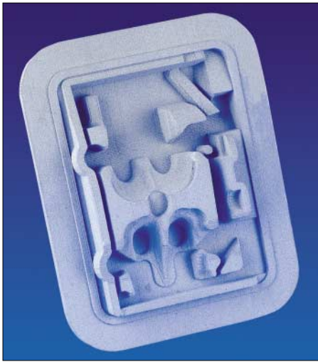
Mit einem Metalldrucker lassen sich auch komplizierte Teile herstellen. Foto: ILT
