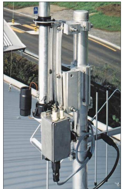
Bild 6: Bei diesem Kippmechanismus bleibt die Antennenbasis drehbar mit dem Mastrohr verbunden. Fotos: HB9PL
