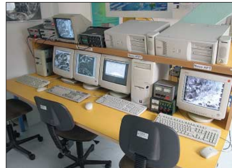
Empfangseinrichtung für NOAA- und METEOSAT-Signale, betrieben im Rahmen der Amateurfunkstation an der HTL Innsbruck. Fotos: OE7KHI
