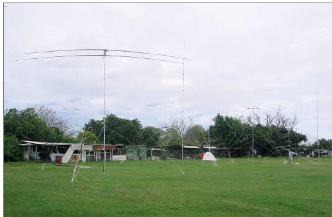
Das Antennenfeld des SSB-Camps auf dem Sportplatz (Inselplateau) mit vier Yagis, zwei Delta Loops und zwei Vertikalantennen.
