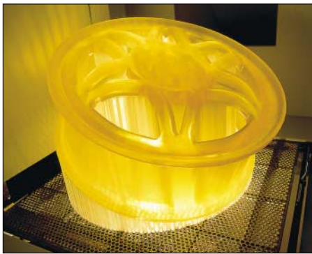
Selbst große Kunststoffmodelle lassen sich mit 3D-Druckern in kurzer Zeit herstellen.
